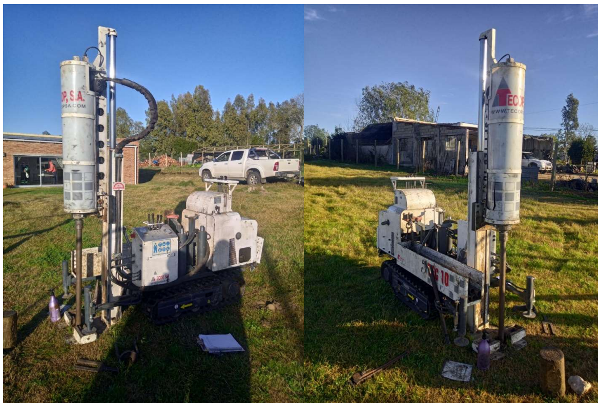
Figura 2. Equipo de perforación y ejecución de ensayos SPT utilizado en el Estudio
